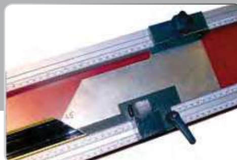
Wymiarowanie listwy po obwodzie wewnętrznym i zewnętrznym
